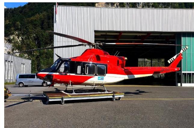
De son côté, le modèle 412 a vu le jour en 1979. Son rotor quadripale de 14 mètres bénéficie d'une puissance totale de 2.500 chevaux fournie par un Twin Pack Pratt & Whitney PT6T-3D. L'engin est ainsi capable de transporter treize passagers ou trois tonnes de fret à la vitesse de 226 km/h.
