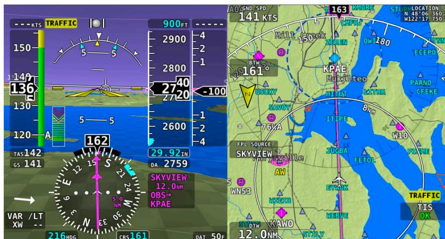
Figure 150 - Mode OBS : avion sur le QDM
