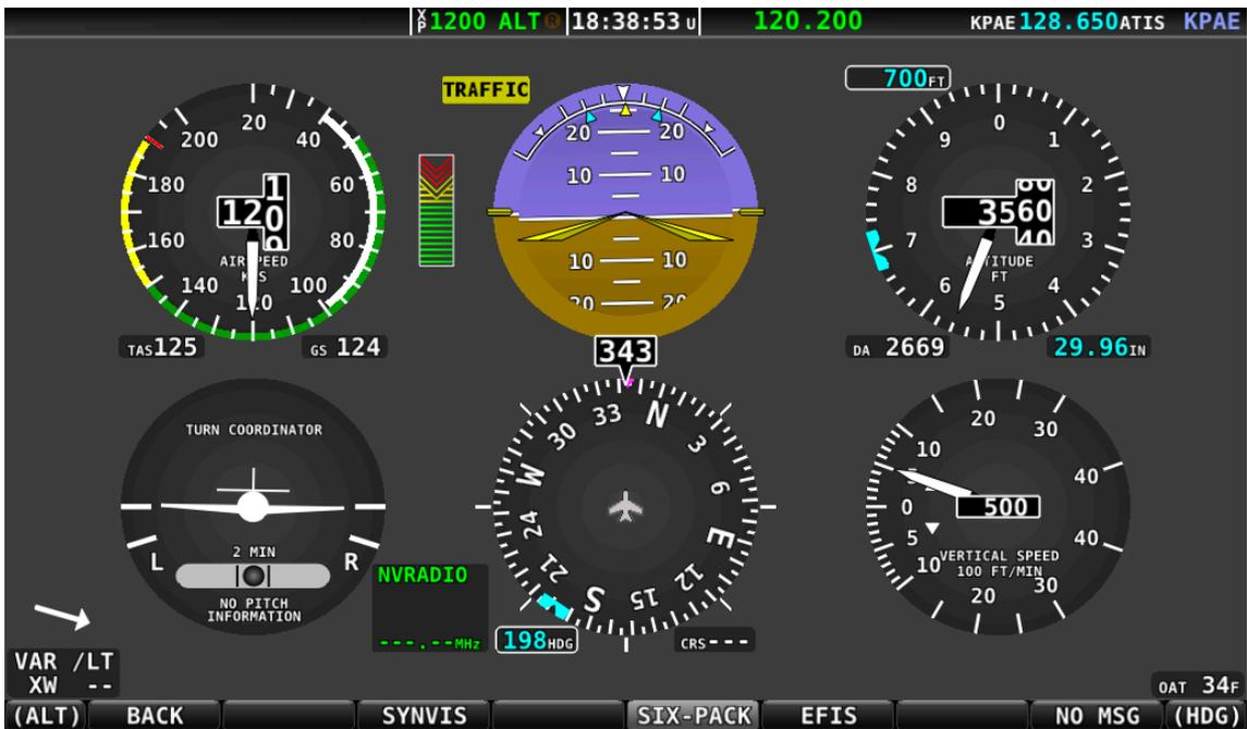
Figure 53 – PFD analogique avec six instruments sans vision synthétique
