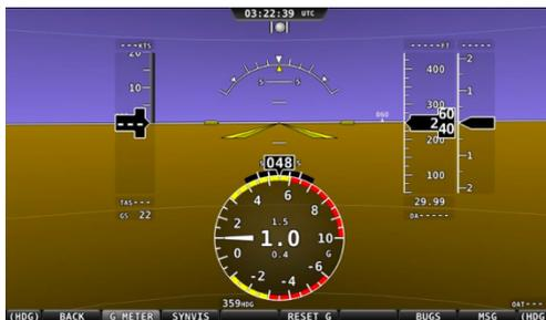
L'accéléromètre affiche une aiguille analogique qui indique l'accélération instantanée que subit l'avion. Il présente une partie jaune et une partie rouge qui dépendent de la configuration, et qui permettent de voir visuellement les limites de l'avion. L'accélération est également affichée numériquement au centre de l'indicateur, ainsi que l'accélération max et mini.
