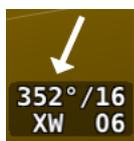
Les informations concernant le vecteur vent sont affichées dans le coin inférieur gauche du PFD. La flèche blanche indique la direction relative du vent par rapport à la direction du vol. La force du vent, sa direction et la composante de vent traversier sont présentées sous forme de texte.
