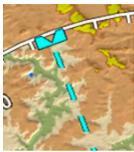
Le bug de cap ci-contre est représenté de couleur cyan. Lorsqu’on déplace le bug de cap, une ligne pointillée de couleur cyan s’affiche entre l’avion et le bug.
