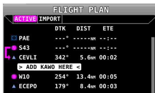
Figure 145 – Insertion d'un point dans le Plan de Vol
