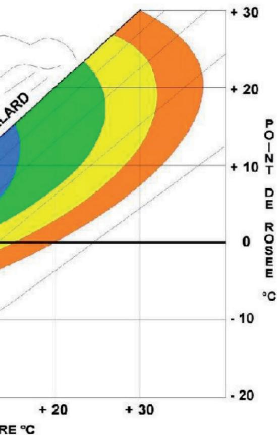
La comparaison de la température avec la température du point de rosée est un indice précurseur du givrage carburateur.
