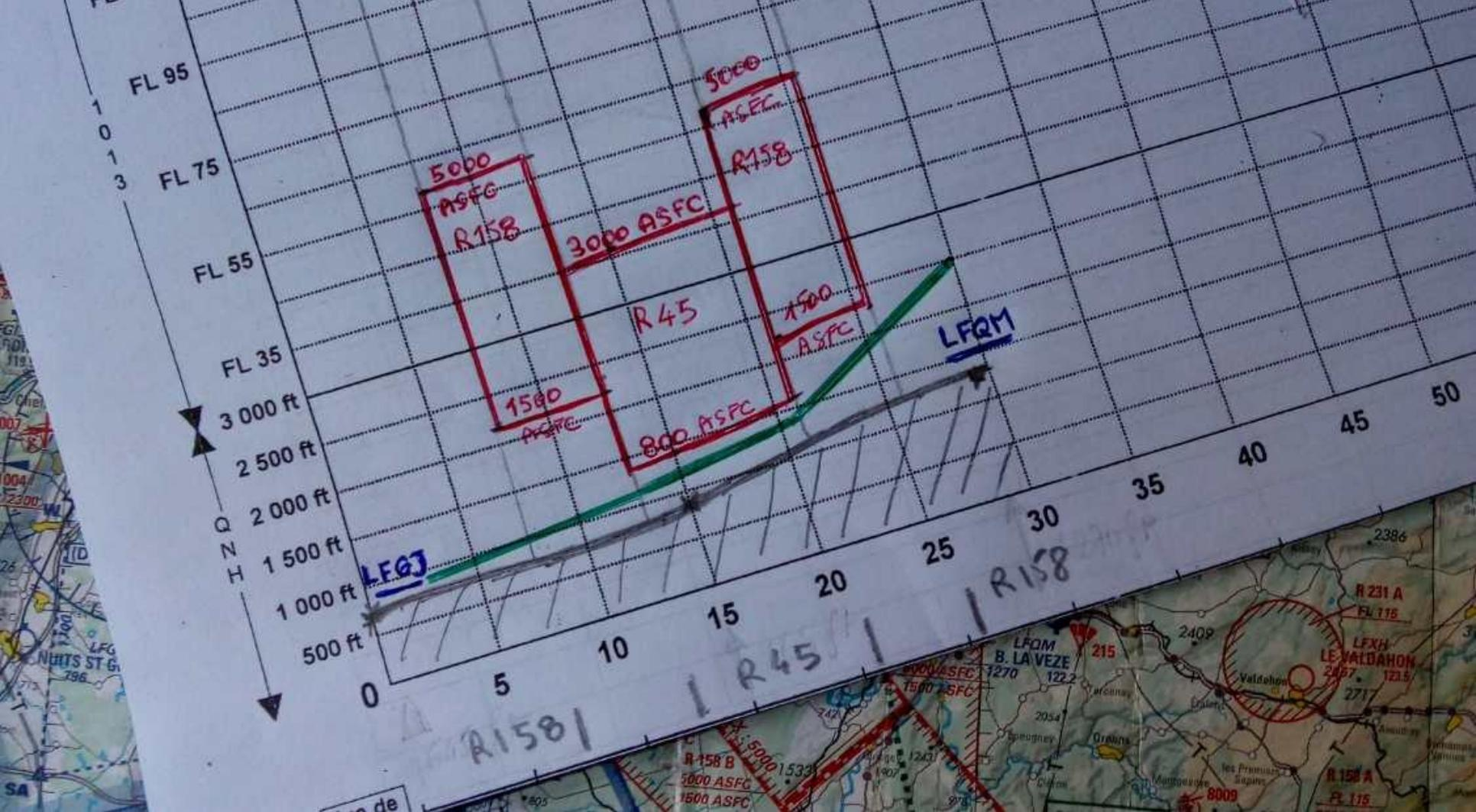
6° Tracer le profil en verticale de la route à suivre . Dans ce cas ,où les zones sont actives possibilité de passer sous la R45 , entre les 500 ft réglementaires et le plancher 800ft ASFC de cette zone.
