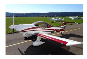
L'un comme l'autre peut recevoir un Rotax 912 de 80 chevaux, un 912S de 100 chevaux ou un 914UL de 115 chevaux. Ces mécaniques autorisent des vitesses de croisière de 258 km/h, 269 km/h et 290 km/h. Grâce à elles, l'appareil prend son essor au terme d'une course de 250 mètres. Les options permettent d'équiper ce dernier d'un parachute balistique de secours, d'un pilote automatique, d'un GPS, d'un phare d'atterrissage et de feux de navigation.
