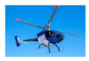
Le CoAX 600 est muni d'un six cylindres UL Power 390iS de 3,8 litres qui fournit 160 chevaux à 3.300 tours par minute. Cette variante se démarque des précédente par sa masse à vide de 340 kilos ainsi que par sa masse maximale atteignant 600 kilos. Un exemplaire de ce type sera prochainement modifié par la société Piasecki. Il recevra alors une pile à combustible HyPoint qui fonctionne grâce à de l'hydrogène.
