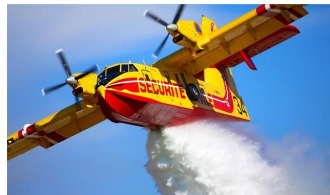
Les Large Air Tanker sont des aéronefs plus grand, tels que le Conair Q400MR, qui larguent entre 10 et 15 tonnes d'eau à environ 150 pieds. Les Very Large Air Tanker sont d'anciens avions de ligne qui déversent environ 45 tonnes d'eau à plus de 250 pieds. Les ingénieurs ont également créé des citernes amovibles, ou Modular Airborne Firefighting System, qui permettent de transformer la plupart des appareils militaires de transport en bombardiers d'eau.
